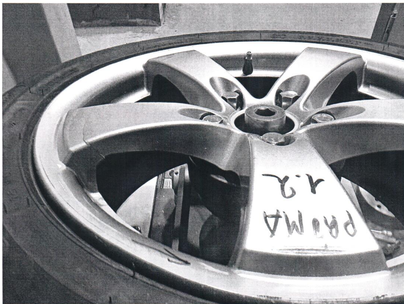
Рисунок 1 – Трещина в соединении спицы с ободом. Герметичность сохранена.
