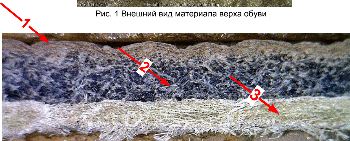
Рис. 2 Поперечный срез материалов обуви - 1 – пленочное покрытие, 2 -кожевенные волокна верха обуви, 3 – кожевенные волокна подкладки
