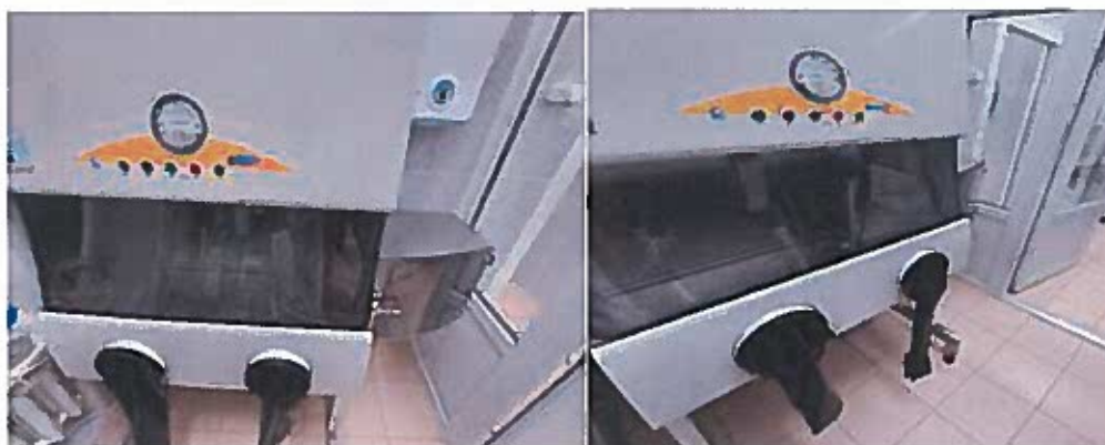
Рисунок 1 - Используемый в работе в качестве аэрозольной камеры бокс III класса биологической безопасности.
